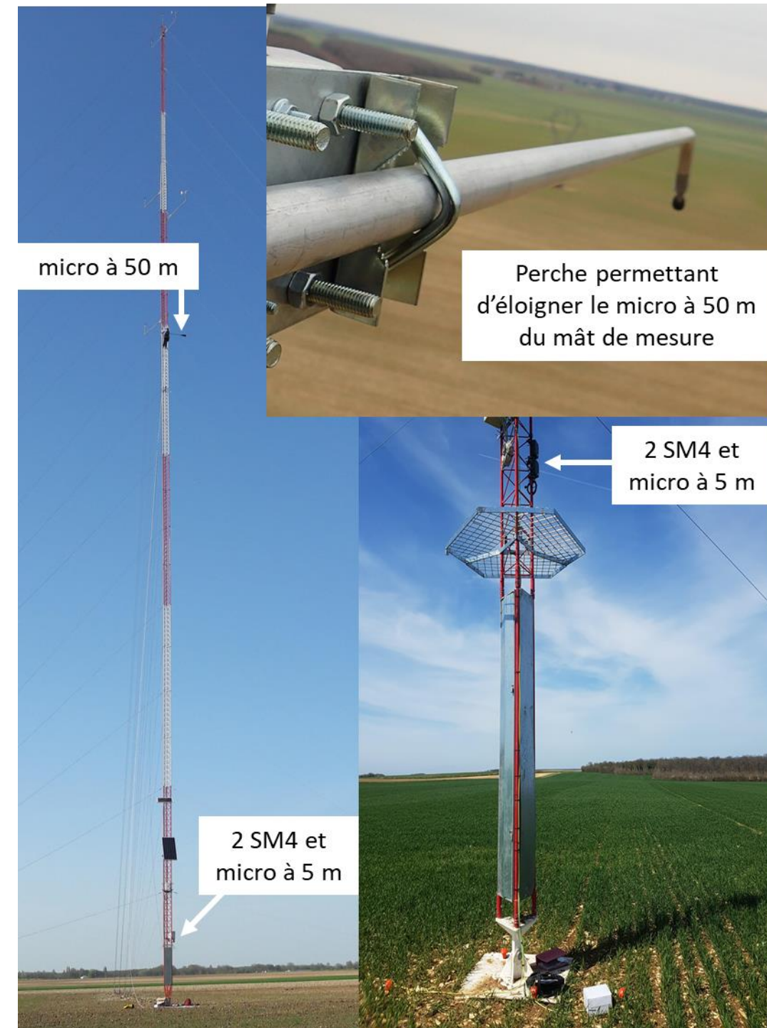
Figure 6 : Position des 2 SM4 et des micros sur le mât de mesure
